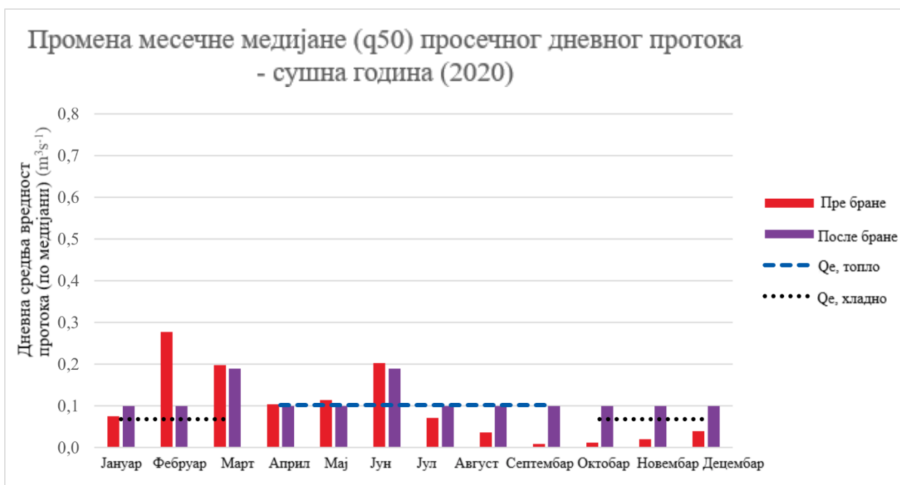
Слика 20 Пример сушне године (2020): месечна медијана (q50) дневног просечног протока на брани Памбуковица, процењена на основу посматраних података (скалираних са станице Уб, црвено) и моделирана према шеми (љубичасто)
